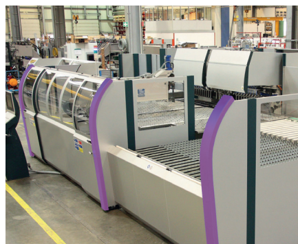
Gebogene Verkleidungssäulen sorgen hier für anwendungssichere Blechbearbeitungsmaschinen.
